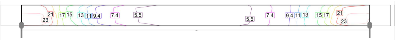
Wartości konserwacji, poziome natężenie oświetlenia [lx] (Izoluksy)
