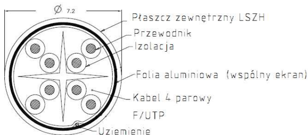
Rys. Budowa kabla kat. 6 F/UTP
