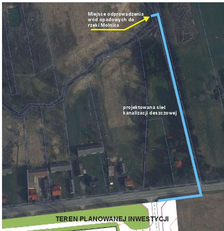
Ryc. 15 Przebieg projektowanej sieci kanalizacji deszczowej.
