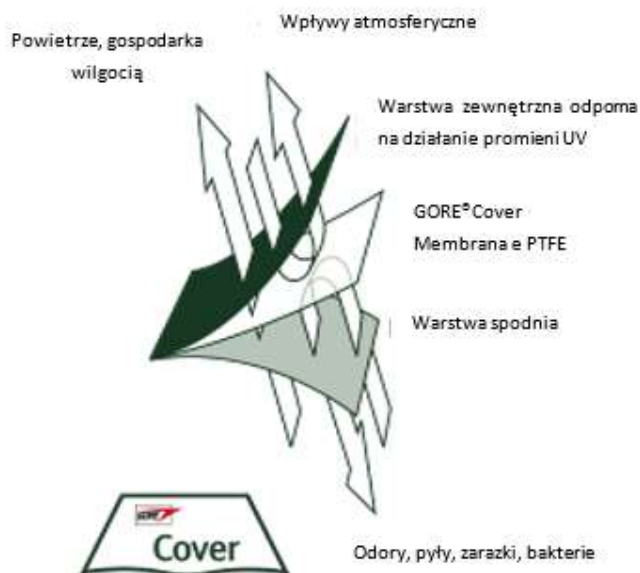
Rysunek 7 Schemat funkcjonowania zamknięcia reaktora membraną GORE®Cover
