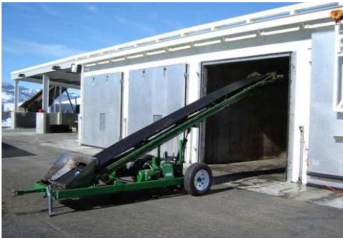
Rysunek 46 Instalacja do kompostowania – reaktory żelbetowe w technologii SV Composter
