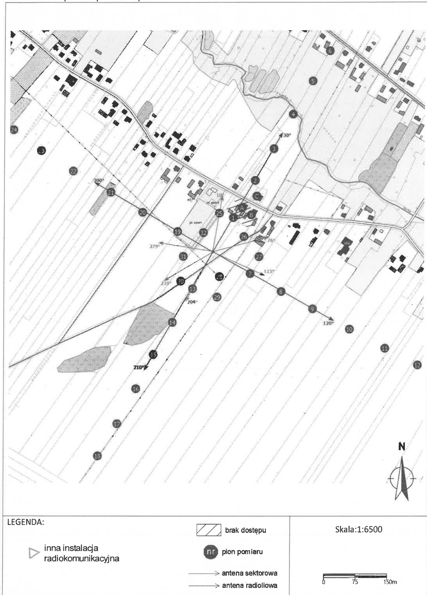
Załącznik 2. Widok pionów pomiarowych
