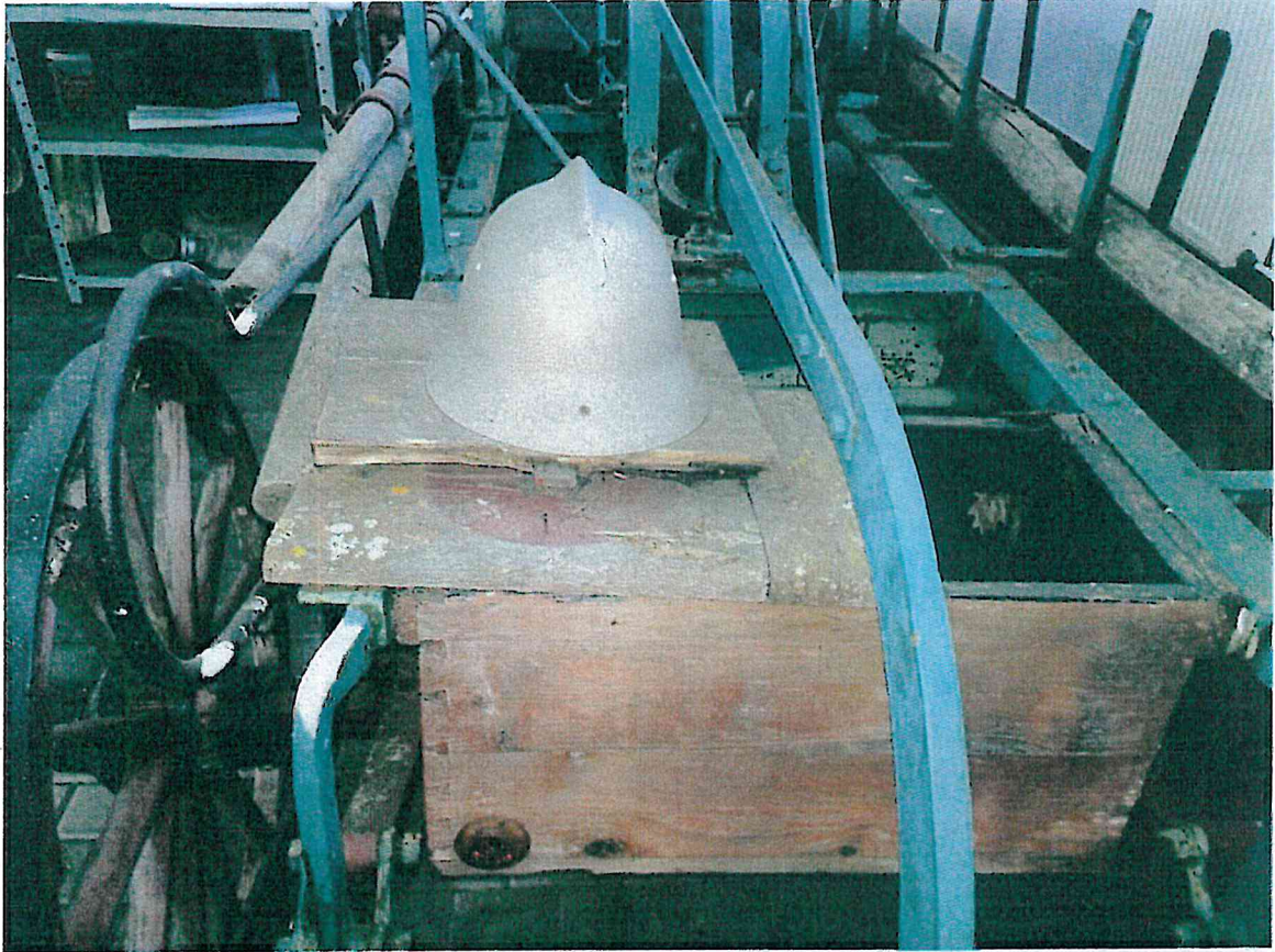
Fot 5 Rudna. Pompa strażacka. 1912. Fabryka Fladera. Stan na 2016. Widoczny zły stan wozu strażackiego z licznymi ubytkami, ogniskami korozji, zbutwiałym drewnem, przemalowaniami powierzchni. Helm strażacki również przemalowany.
