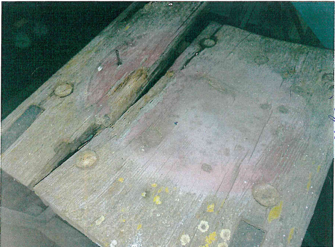
Fot 4 Rudna. Pompa strażacka. 1912. Fabryka Fladera. Stan na 2016. Widoczny bardzo zły stan zachowania drewnianych elementów. Widoczne pęknięcia, ubytki drewna, porosty i zbutwienie drewna.
