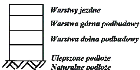
Rys. 3. Konstrukcja nawierzchni utwardzonego pobocza
