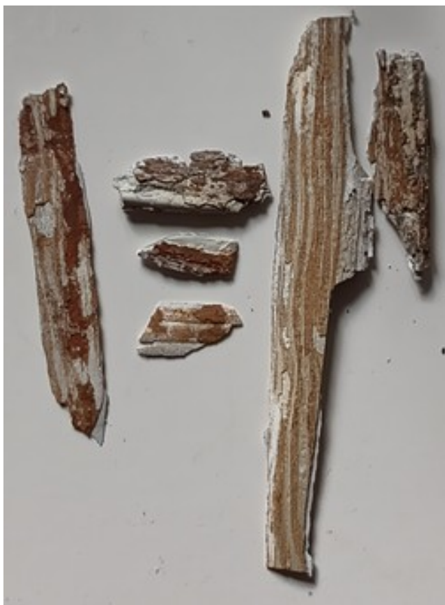
FOT.6 Zbliżenie na część zewnętrzną okna poddasza elewacji wschodniej. Widoczne resztki ciemnobrązowego koloru pierwotnego leżące bezpośrednio na drewnie okna.
