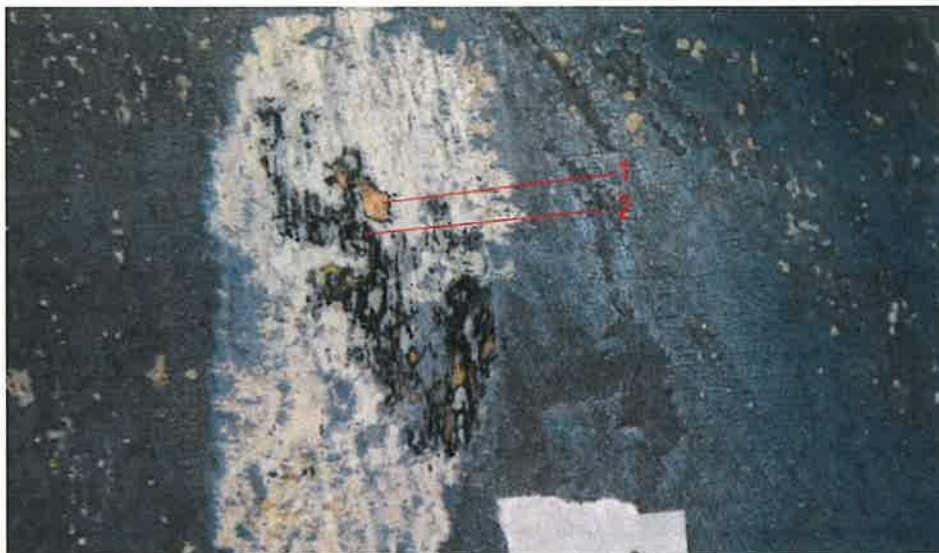
59. Trzon kolumny (pkt 21) – widoczne: 1/ drewno, 2/ w. malarska czarna. Pozostałe warstwy analogiczne jak w punktach 11 i 12.
