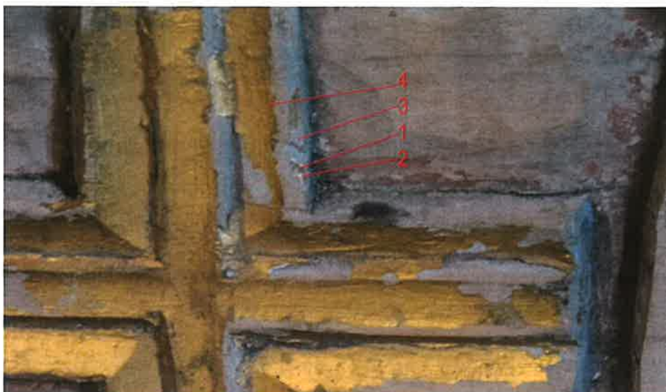
98. Świecznik ustawiony po północnej stronie ołtarza. Stratygrafia nawarstwień analogiczna również dla pozostałych partii symboli: 1/ drewno, 2/ cienka warstwa gruntu, 3/ warstwa malarska podmalowania, 4/ warstwa malarska wykonana farbą metaliczną.
