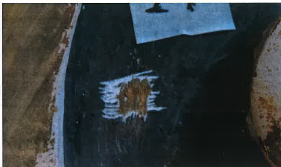
60. Fragment dekoracji snycerskiej – uszaka (pkt 14) – w odkrywce drewno pozbawione warstw pierwotnych i wtórnych, na którym warstwa gruntu białego i ciemnoniebieska w. malarska.
