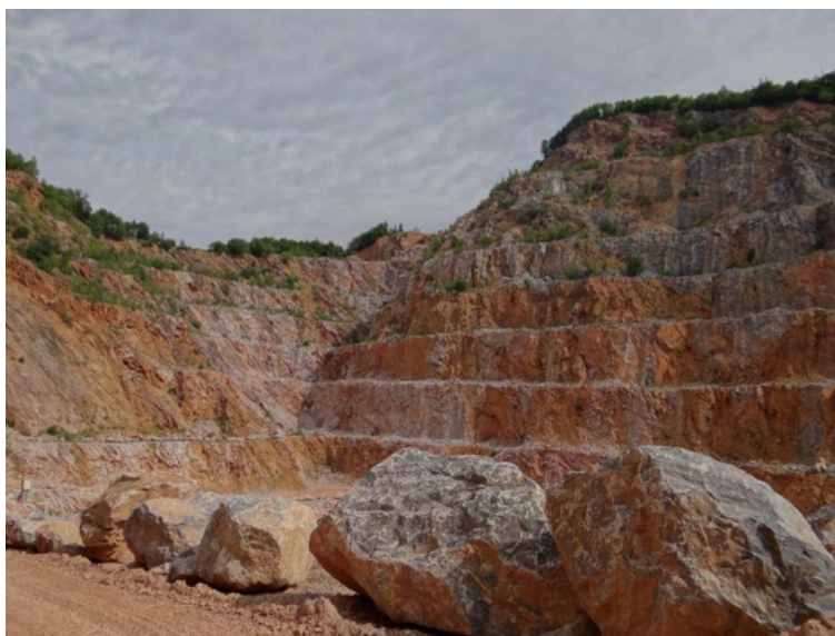
Fotografia 1. Aktualnie wyrobisko wapienia na górze Połom z widocznym układem ścian i półek eksploatacyjnych (fot. AWR)
