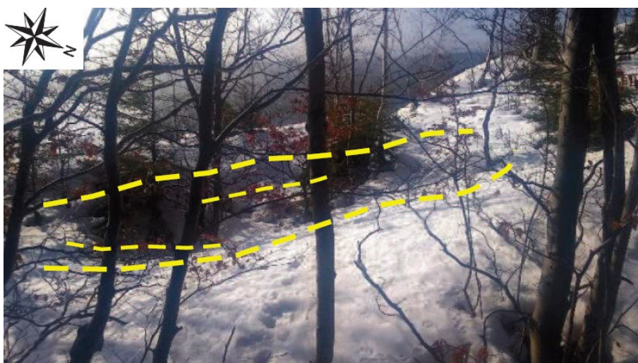
Fotografia 13. Deformacje powierzchni oraz szczeliny z rozciągania - 01.2019 r. (fot. Lhoist S.A.)
