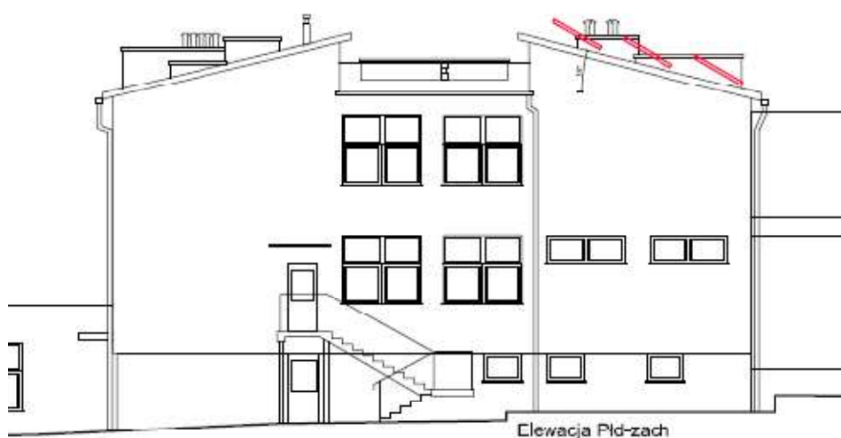
mocowanie pod kątem 30 stopni 3 rzędy paneli fotowoltaicznych
