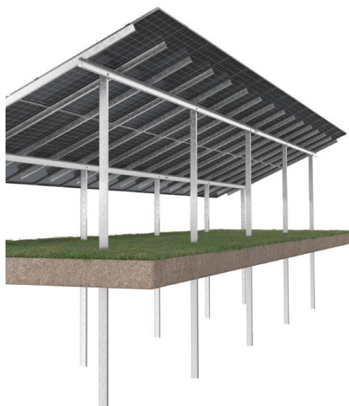
Rysunek 27 Sposób posadowienia stelaży z panelami PV w gruncie. Źródło: https://corab.pl
