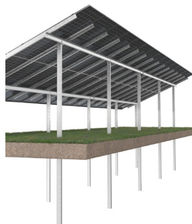
Rysunek 30 Sposób posadowienia stelaży z panelami PV w gruncie. Źródło: https://corab.pl
