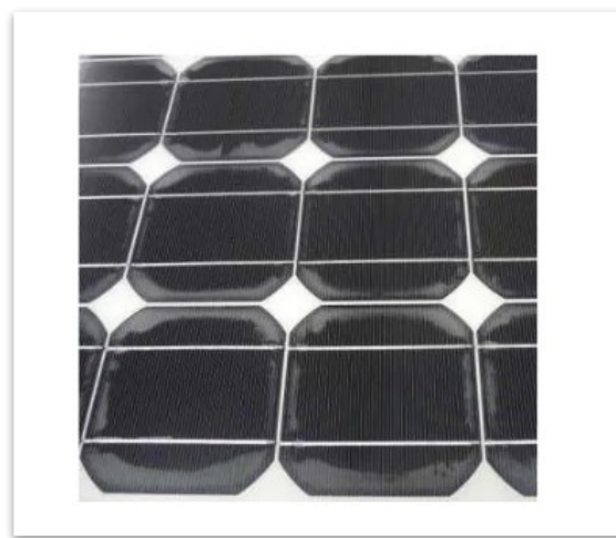
Rysunek 37 Przykład delaminacji paneli PV. Źródło: IEA International Energy Agency, Review of Failures of Photovoltaic Modules - Report IEA-PVPS T13-01:2014
