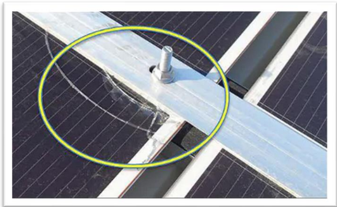
Rysunek 37 Przykład pęknięcia powłoki panelu PV. IEA International Energy Agency, Review of Failures of Photovoltaic Modules - Report IEA-PVPS T13-01:2014
