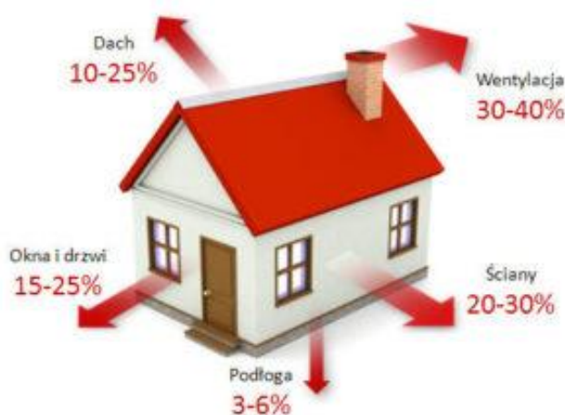
Rysunek 22. Procentowa strata ciepła w budynku 10
