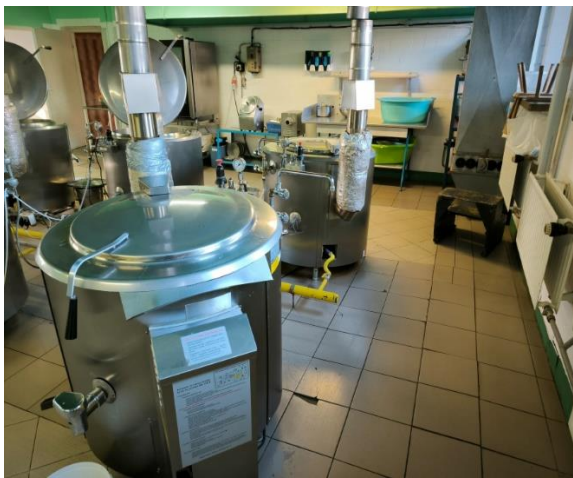
ZDJĘCIE 7 WYPOSAŻENIE KUCHNI SZPITALNEJ: PIEC KONWEKCYJNO-PAROWY, KOTŁY WARZELNE. ŹRÓDŁO: SP ZOZ W KRASNYMSTAWIE.
