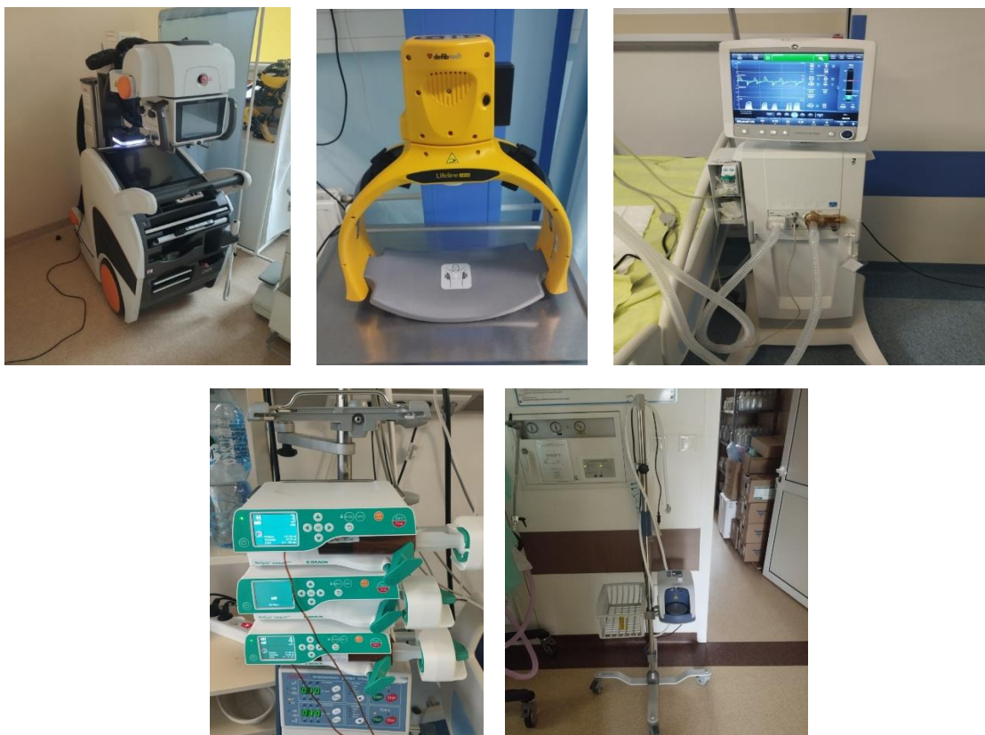
Zdjęcie 11 Od lewej góry: Aparat RTG, urządzenie do kompresji, respirator, pompa strzykawkowa, aparat do tlenoterapii. Źródło SP ZOZ w Krasnymstawie.
