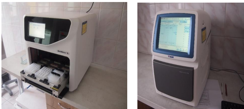
Zdjęcie 7 Automatyczny ekstraktor do izolacji materiału genetycznego z wirusa SARS-COV-2 oraz termocykler do detekcji SARS-COV-2. Źródło: SP ZOZ w Krasnymstawie
