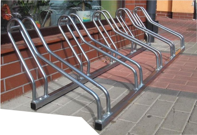
STOJAK NA ROWERY NA PARKINGU ROWEROWYM STOJAK DLA 5 ROWERÓW WYKONANY Z PROFILI STAŁOWYCH CYNKOWANYCH OGNIOWO STOJAK MOCOWANY KOTWAMI DO BETONOWYCH STÓP FUNDAMENTOWYCH OSADZONYCH W PODŁOŻU GRUNTOWYM ZAMONTOWAĆ 6szt.
