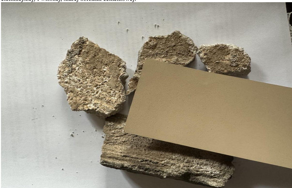
Fot. 22. Fragmenty próbek tynku z elewacji budynku przy ul. Grabowskiej 1 w Mikstacie, widoczna stratygrafia warstw z fragmentami oryginalnej ugrowo-beżowej warstwy polichromii (jaśniejszej oraz kolejnej, ciemniejszej) i wtórnej, szarej obrzutki cementowej- propozycja kolorystyki - paleta Keim nr 9248.
