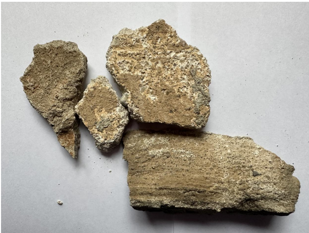
Fot. 21. Fragmenty próbek tynku z elewacji budynku przy ul. Grabowskiej 1 w Mikstacie, widoczna stratygrafia warstw z fragmentami oryginalnej ugrowo-beżowej warstwy polichromii (jaśniejszej oraz kolejnej, ciemniejszej) i wtórnej, szarej obrzutki cementowej.
