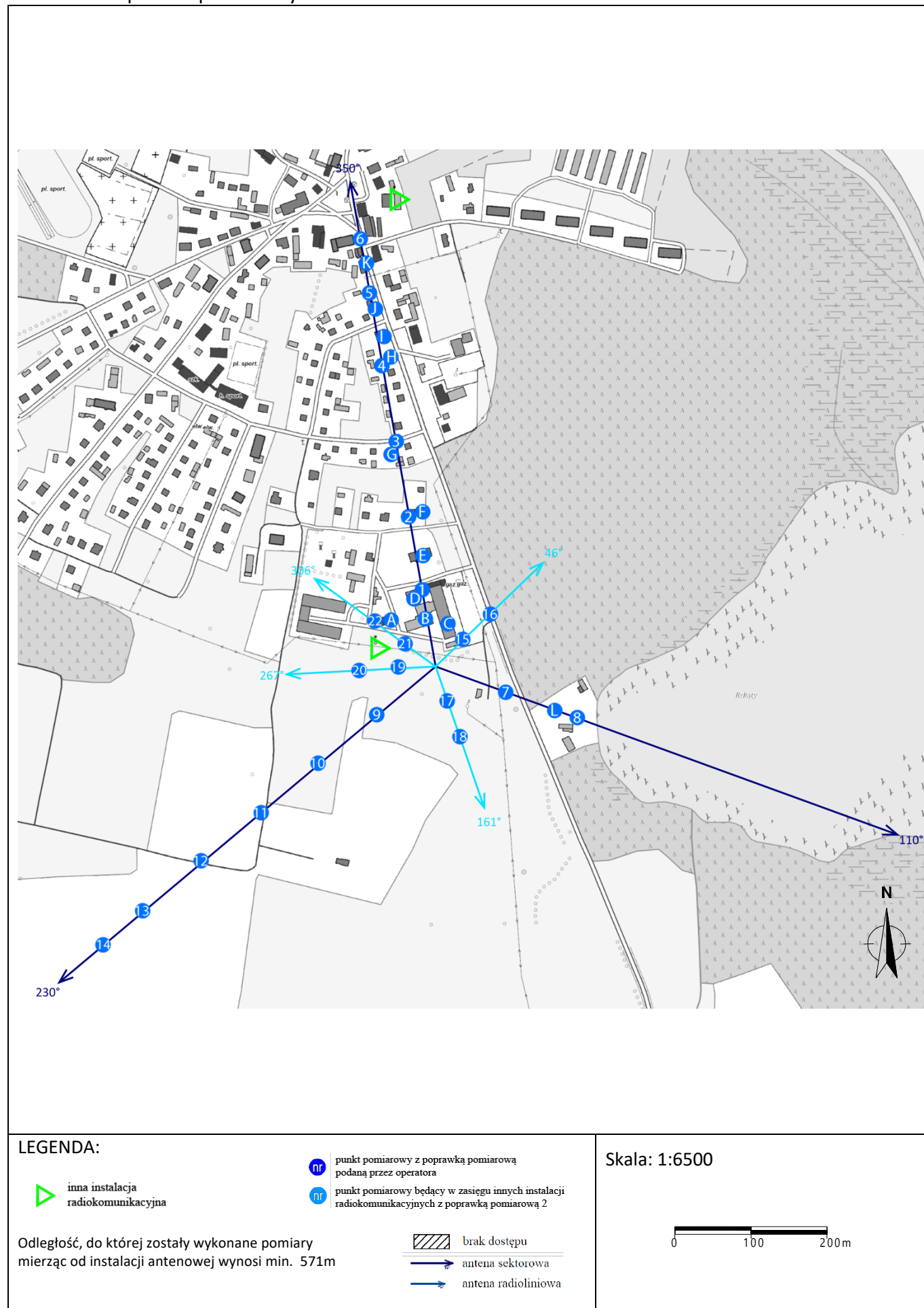
Załącznik 2. Widok pionów pomiarowych
