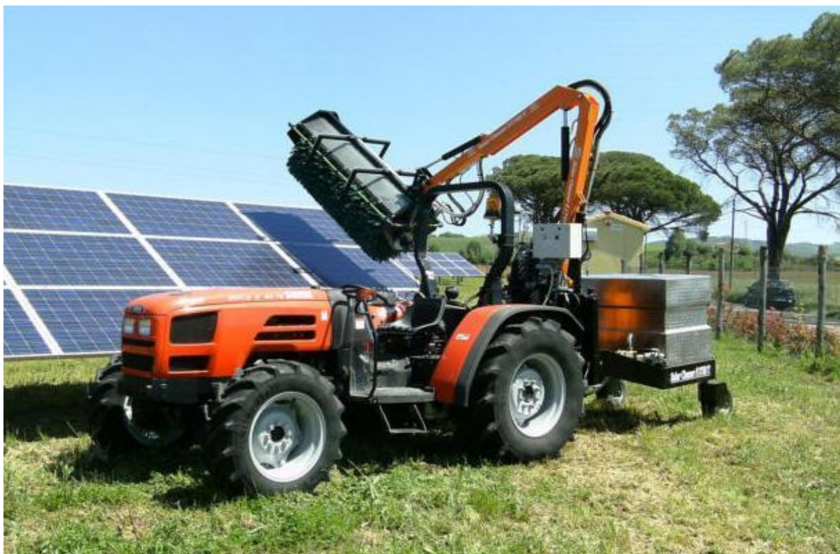
Ryc. nr 15 Maszyna do mycia paneli na farmach fotowoltaicznych Solar Cleaner F1750T
