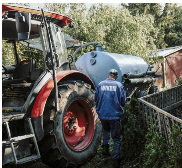
Odbiór ścieków beczką asenizacyjną
