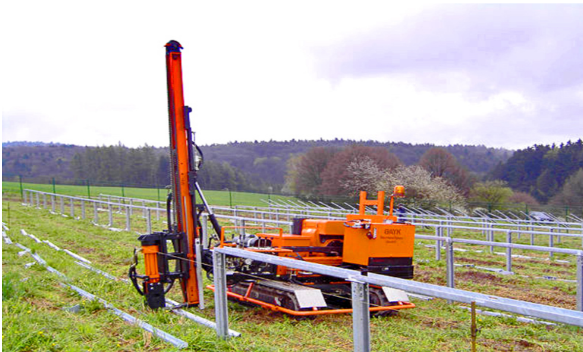
Fot. 1. Maszyna wciskająca konstrukcje stalowe w grunt. Zdjęcie www.projekt-solartechnik.pl .
