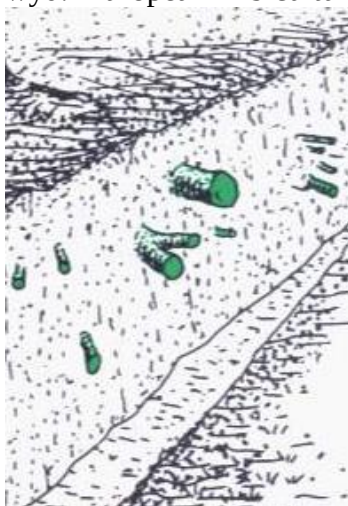
Rys 2 Postępowanie z korzeniami uszkodzonymi w wykopach. Przycięcie korzeni i zabezpieczenie środkiem do pielęgnowania ran (rys. pochodzi z European Treeworker, wyd. European Arbicultural Council).
