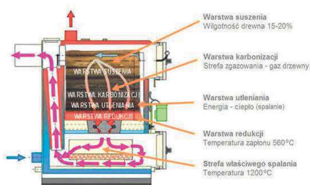
Ryc. 18. Schemat spalania drewna w kotle zgazowującym
