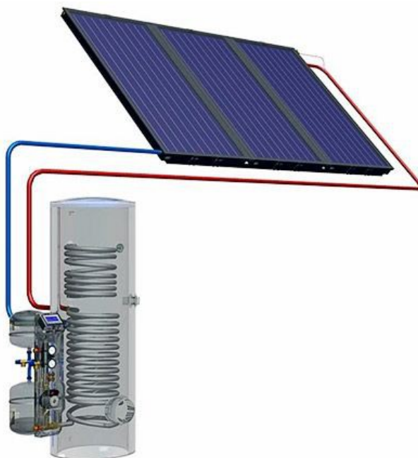
(Schemat działania instalacji solarnej)
