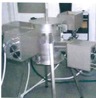
Ryc. Reaktor ATON 2 przeznaczony do utylizacji niewielkich ilości odpadów szczególnie niebezpiecznych
