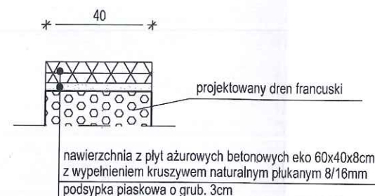
SZCZEGÓŁ F KONSTRUKCJA JEZDNI SKALA 1:20
