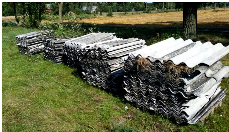
Rys. 2. Złożone płyty azbestowe - faliste (źródło: materiały własne)
