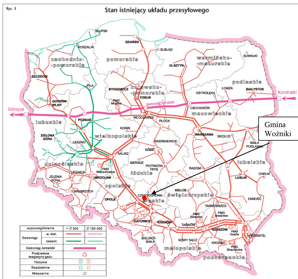
Rys.1 Krajowy system przesyłu gazu ziemnego
