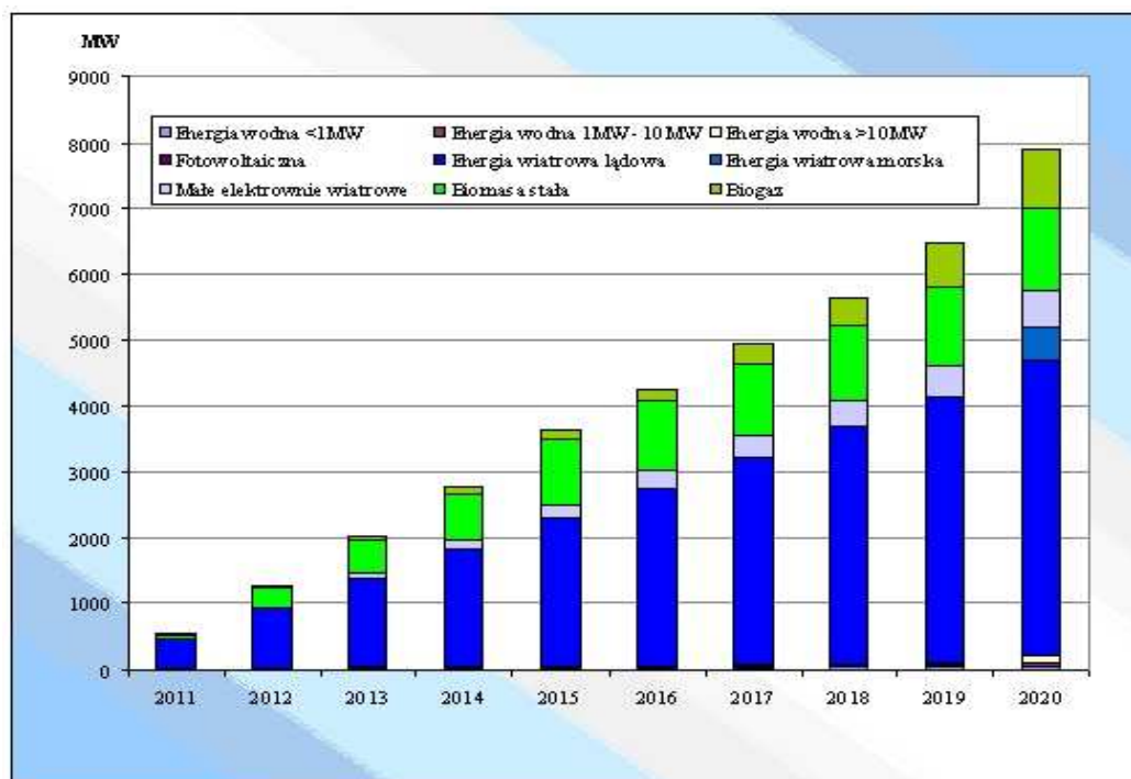
Rysunek 2 Prognozowany przyrost mocy elektrycznych zainstalowanych w OZE w latach 2011-2020 w [MW], [źródło: Instytut Energetyki Odnawialnej (EC BREC IE0)]
