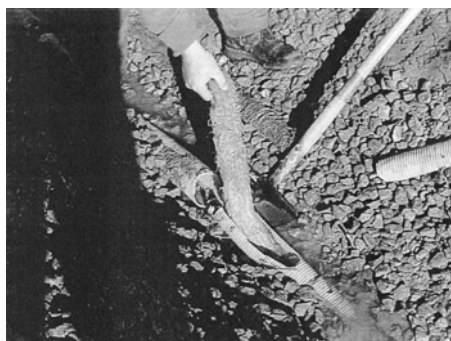
Fot. 1 i 2. Dren rurowy zatkany korzeniami roślin.
