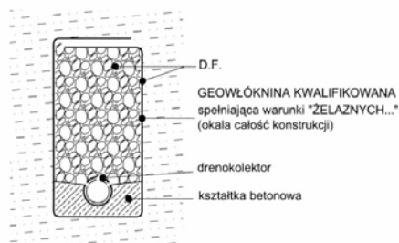
Rys. 4. Sposób umieszczenia drenokolektora w D.F.
