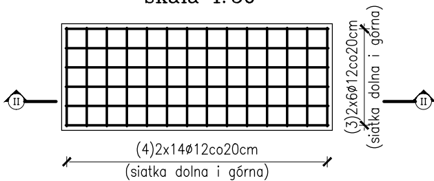
Zbrojenie płyty fundamentowej pod wirówkę dekantacyjną skala 1:50
