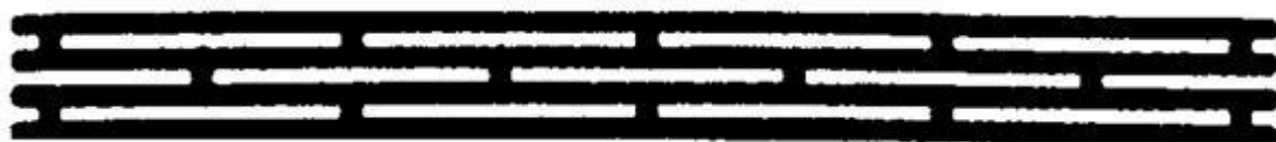
Rys. 2. Geosiatka komórkowa w stanie złożonym, stosowanym przy transporcie i składowaniu
