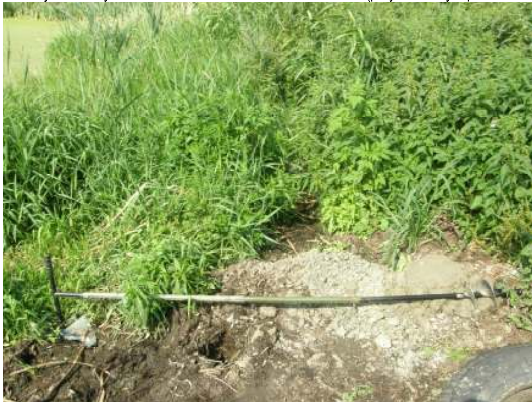
Ilustracja nr 3.- wykonania odwiertów w nabrzeżach zbiornika wydobyte próbki gruntu do badań.
