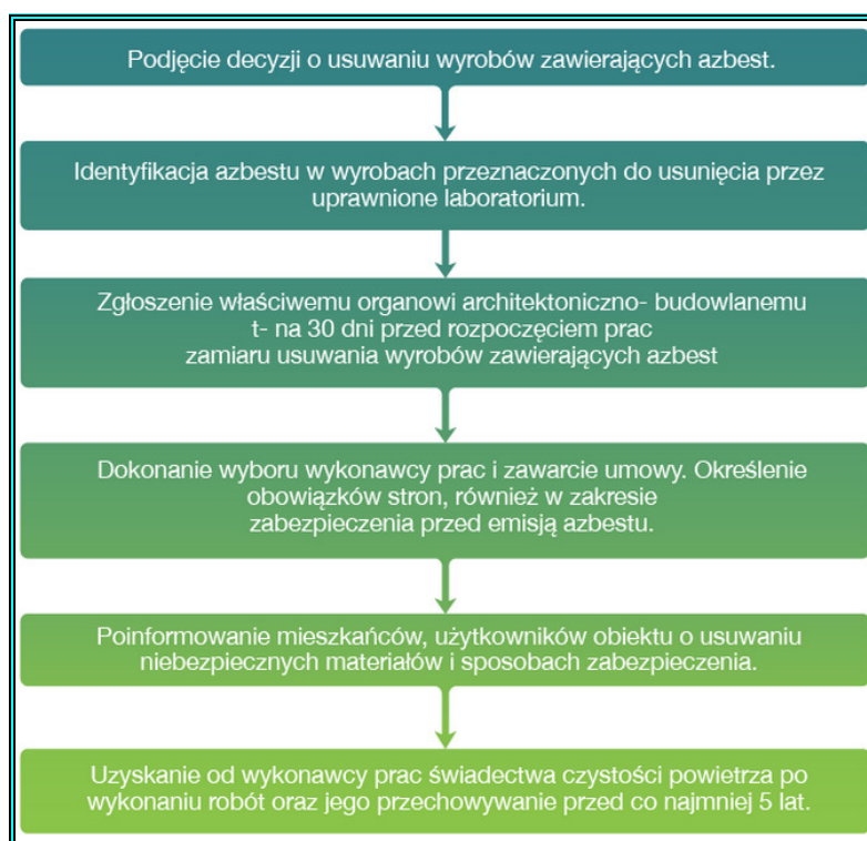
Ryc. 5. Procedura 2 - dotycząca usuwania wyrobów zawierających azbest
