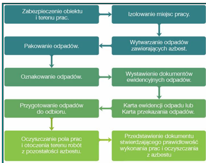
Ryc. 7. Procedura 4 - dotycząca prac polegających na usuwaniu wyrobów zawierających azbest - wytwarzaniu odpadów niebezpiecznych, wraz z oczyszczaniem obiektu (terenu) instalacji.
