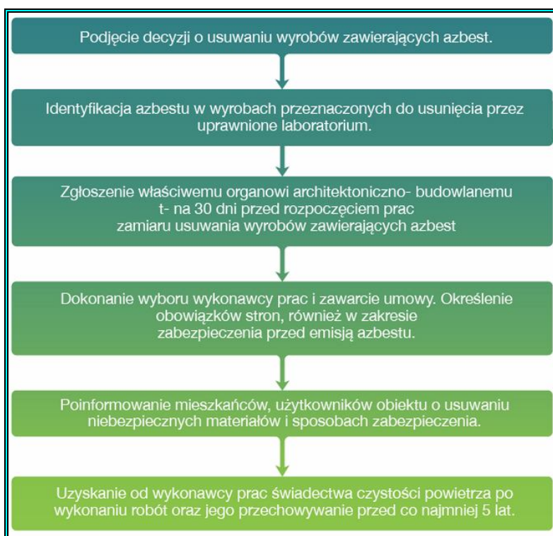
Ryc. 5. Procedura 2 - dotycząca obowiązków przy usuwaniu wyrobów zawierających azbest
