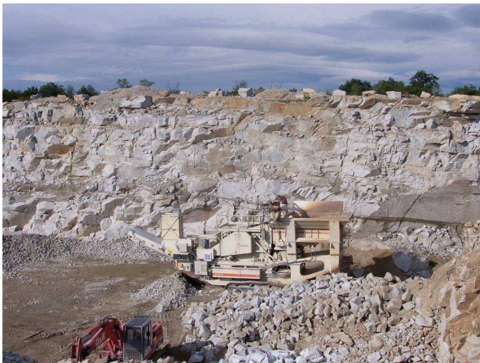
Fot. nr 6. Mobilny węzeł kruszący w wyrobisku eksploatacyjnym
