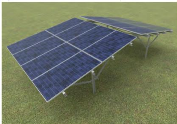
Rysunek 4. Rzut na przykładową konstrukcję stołów z panelami fotowoltaicznymi w układzie wschód - zachód (rozwiązanie typowe, najczęściej stosowane, źródło: strony producentów).
