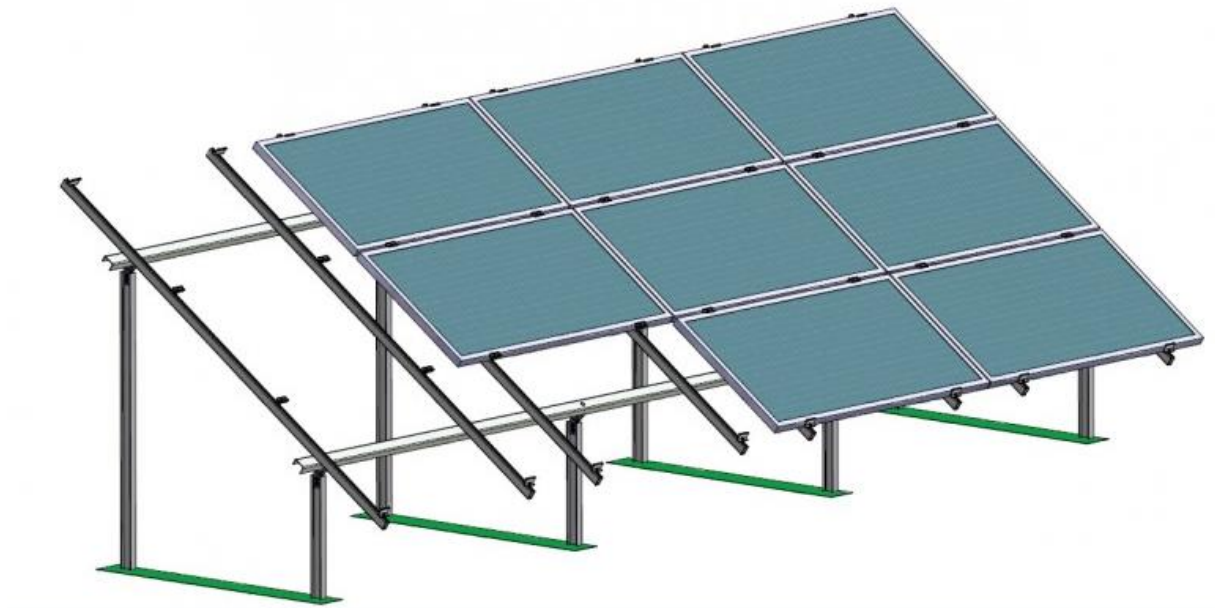
Rysunek 1 Schemat konstrukcji stelażu nośnego dla paneli fotowoltaicznych.
