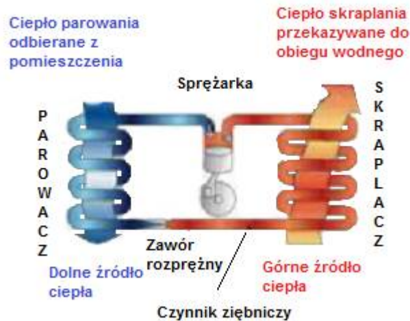
Rysunek 31 Tryb pracy chłodzenia rewersyjnej pompy ciepła
