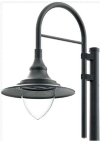
Oprawa ledowa typ: OW LED Kod 2109034/4/... Nazwa /... OW LED 60 Moc 60 W Moc całkowita 67 W Prąd przewodzenia LED830 mA Temperatura barwowa 4000 K Strumień świetlny diod LED 8950 lm Strumień świetlny oprawy 8000 lm Efektywność świetlna 119 lm/W Waga oprawy 6,3 kg Stopień ochrony: IP 66 Klosz PMMA przezroczysty do OW LED, 0,57 kg ( 690893 )
