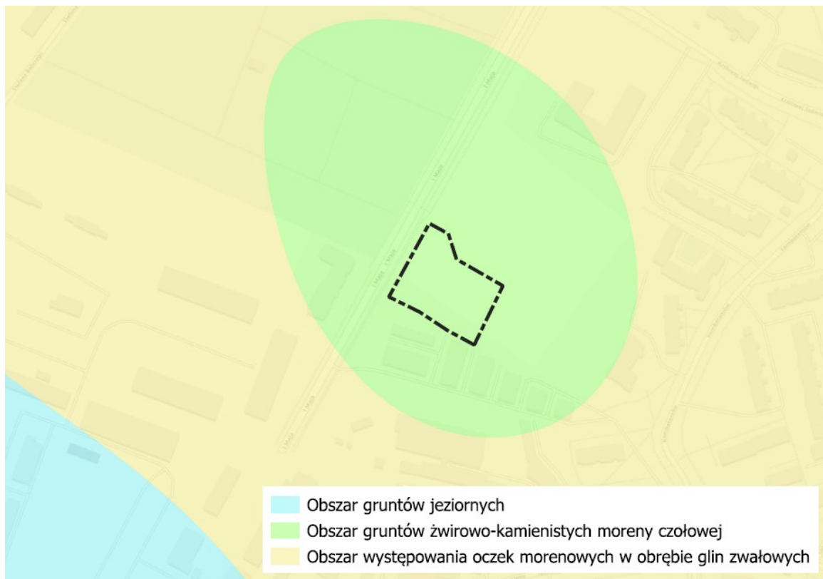
Ryc. Grunty w rejonie mpzp
