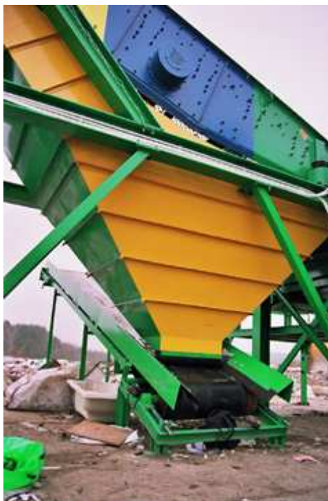
Fot. 2. Urządzenie przesiewające modułowej stacji segregacji
