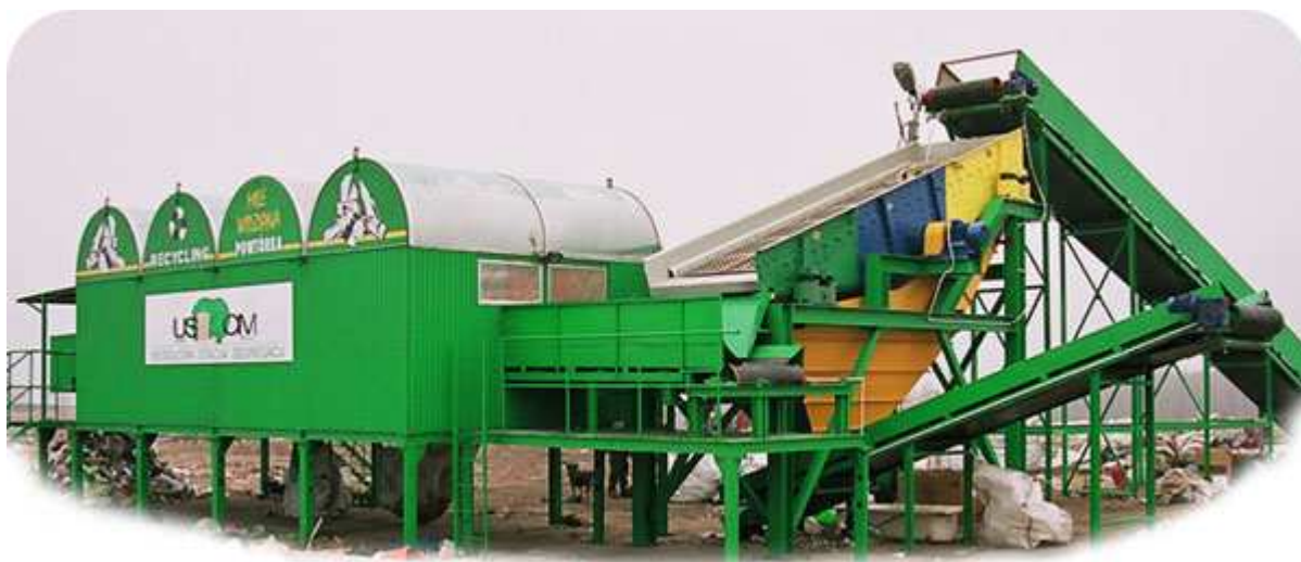
Fot.5. Modułowa stacja segregacji odpadów
