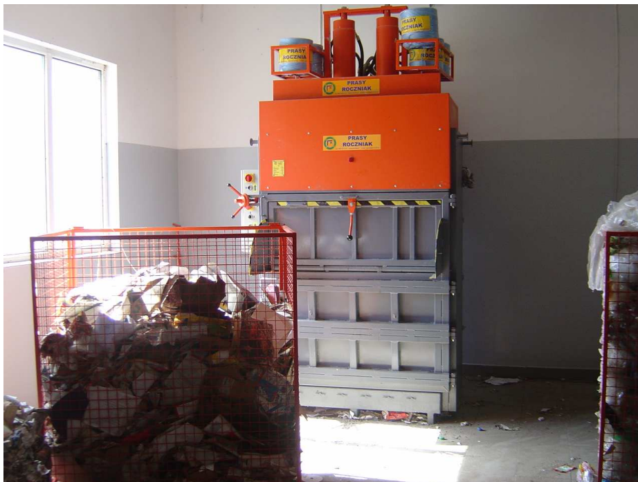
Fot.3. Linia segregacji odpadów firmy „USKOM” w Mławie – prasa do zgniatania rozsegregowanych odpadów opakowaniowych
