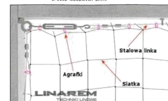
SPOSÓB MOCOWANIA SIATKI
