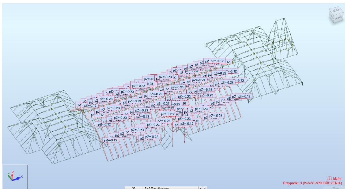
Rys. 7 Przypadek 3 obciążenia więźby – warstwy wykończeniowe [kN/m]
