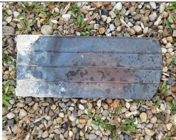
Dachówka w kolorze antracytu, wymiary zewnętrzne 14 cm x 35 cm z profilami podłużnymi
