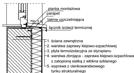
Połączenie systemu ociepleniowego z parapetem
