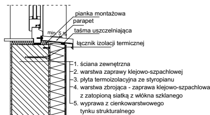
Połączenie systemu ociepleniowego z parapetem
