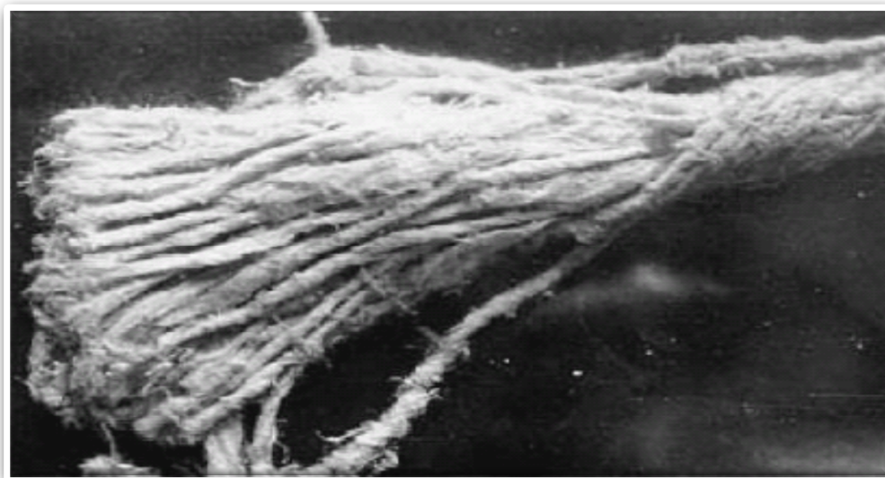
Zdjęcie 5 Sznur azbestowy stosowany w uszczelnieniach izolacji cieplnej
